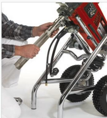
Levier de verrouillage: bloque la pompe en place.
